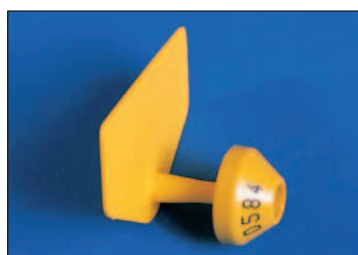
Kicsi és könnyű, fülbe helyezhető jeladó a gyors adattovábbítás érdekében
