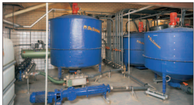
HYDROMIX és 2 tartály, 2 takarmányfajta etetéséhez
