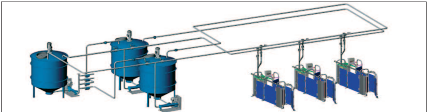
Egy computer által vezérelt folyékonytakarmányozás működési sémája 2 takarmányfajta esetén
